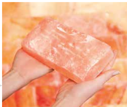
Un mur de sel est constitué de blocs de sel Salgemma spécial d'Indes mesurant 20 x 10 cm
